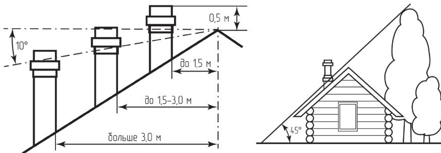
**Рис. 30. Размещение дымохода относительно конька крыши**
