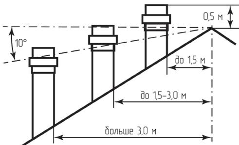
Рис. 30. Размещение дымохода относительно конька крыши
