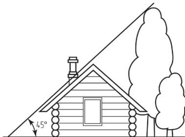
Рис. 31. Нарращивание дымохода при наличии преград непосредственно у зданий
